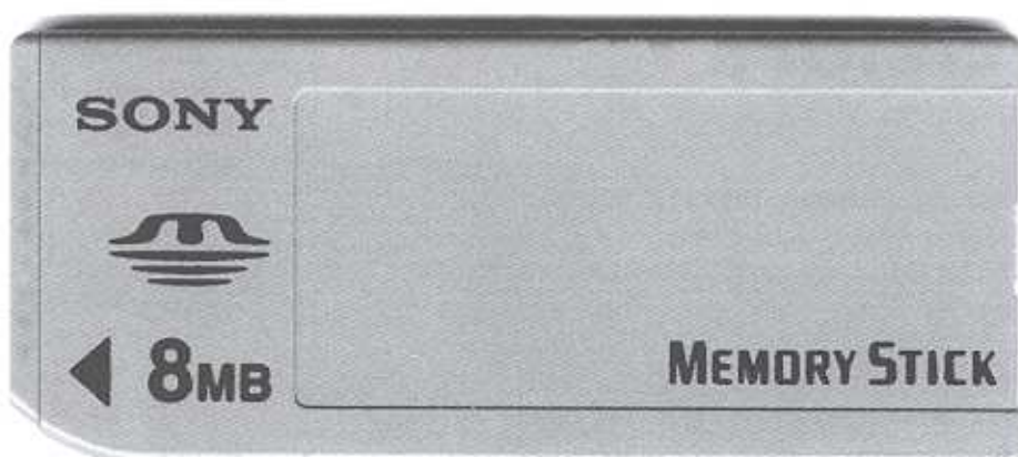
Ett minneskort av typ memory stick från Sony. Detta är första versionen av memory stick den nyare versionen som kallas memory stick duo är betydligt mindre.
